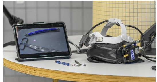
drahtlose Kopfkamera mit Umhängetasche und Vorschau-Display
